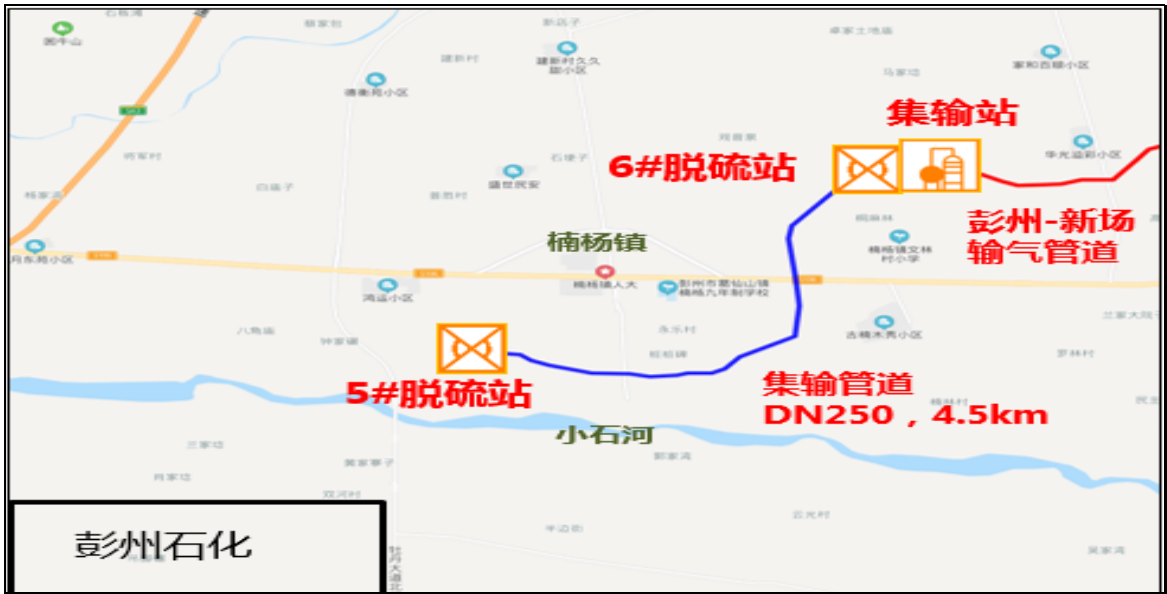
图 2-6 集输管线布置图
