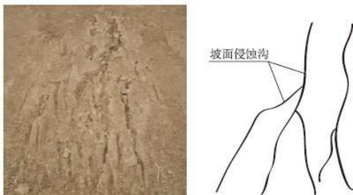
图 6.2-2 侵蚀沟量测法示意图
