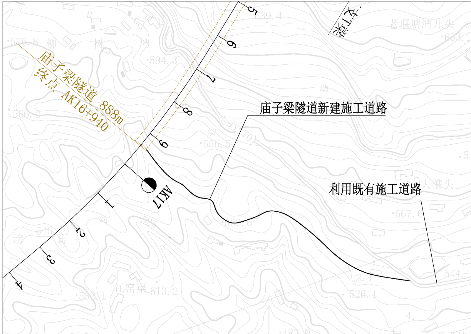
图 2.2-1 庙子梁隧道出口施工道路平面布置图
