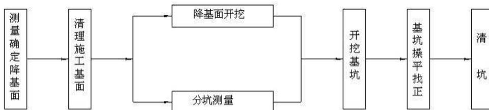
图 2-1 土石方施工流程图
