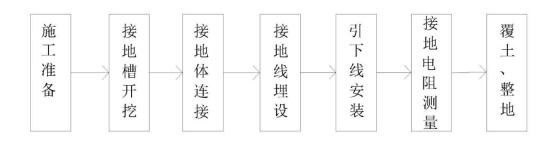
图 2-3 接地工程施工流程图
