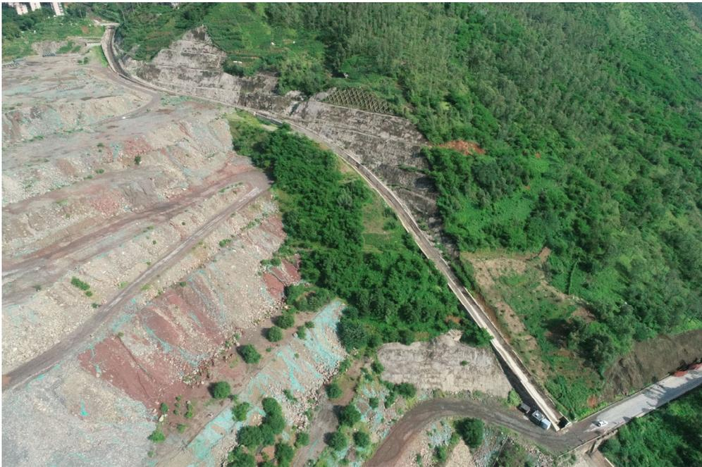
图 1.2-3 石家沟弃渣场泥石流排导槽
