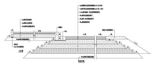
图 2.1-4 G211 改扩建道路路面结构图
