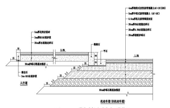
图 2.1-10 学府路新建道路路面结构图
