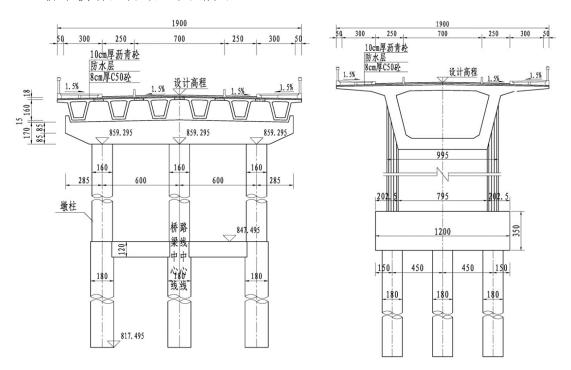
图 2.1-25 连坡湾大渡河大桥横断面示意图
