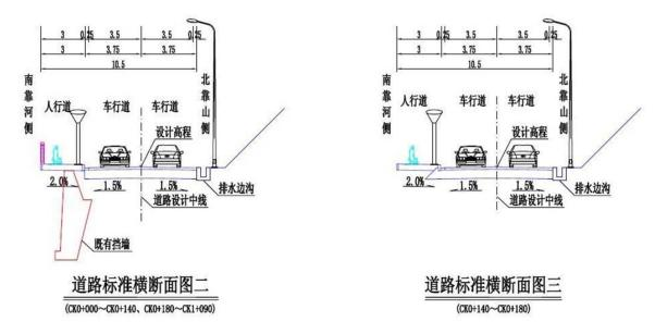
图 2.1-3 S211 改扩建道路标准横断面图 (图中尺寸以 m 计)
