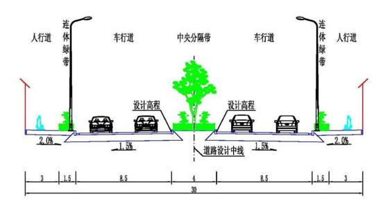
图 2.1-1 G108 改扩建道路路基段标准横断面图 (图中尺寸以 m 计)
