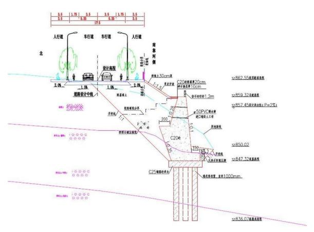
图 2.1-5 岩子路及河堤典型横断面图示意图 (图中尺寸以 m 计)
