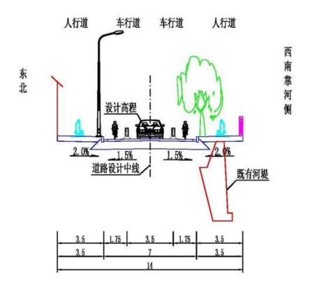
图 2.1-9 学府路典型横断面图示意图 (图中尺寸以 m 计)
