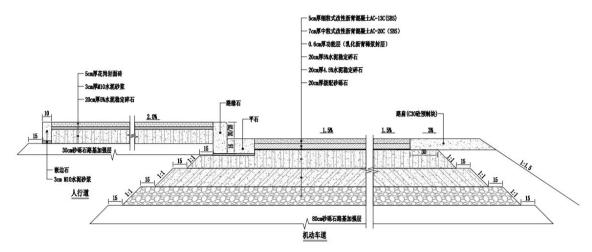
图 2.1-6 岩子路新建道路路面结构图
