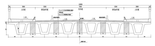
图 2.1-26 连坡湾大渡河大桥路幅布置图
