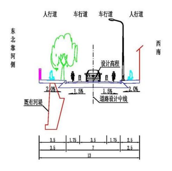
图 2.1-11 电力路典型横断面图示意图 (图中尺寸以 m 计)
