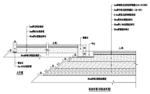
图 2.1-12 电力路新建道路路面结构图
