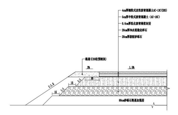
图 2.1-15 上山 1、2号路、1、2号路新建道路路面结构图
