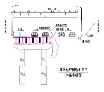
图 2.1-2 G108 改扩建道路半路半桥端标准横断面图 (图中尺寸以 m 计)
