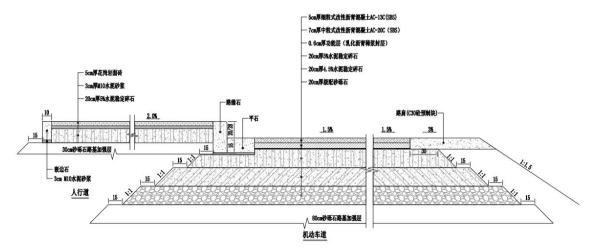
图 2.1-3 G108 改扩建道路路面结构图
